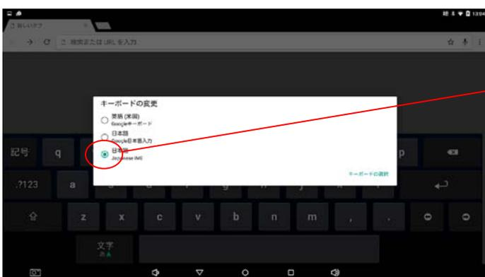
「キーボードの変更」ウィンドウが表示されます。このウィンドウ内には今、Metal Tablet 10 で有効となっている「キーボードと入力方法」が全て表示されます。お使いになるキーボードのラジオボタンをタップして変更してください。以降、選択された「キーボードと入力方法」がご利用頂けます。画面の例は「Japanese IME」が設定されている状態です。
